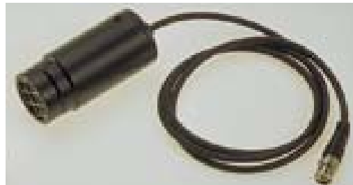
Geiger-Müller rør med ledning og stikforbindelse til tæller
